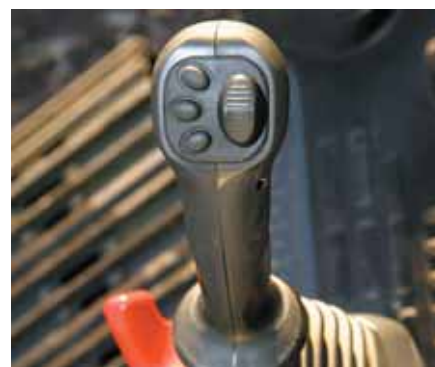
Joysticki z przyciskami proporcjonalnego sterowania osprzętem
