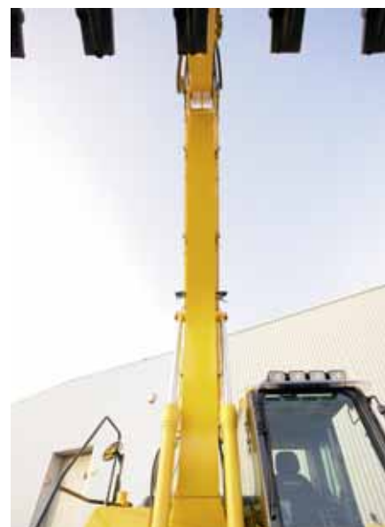
Ściany wyciągnika z jednego kawałka blachy
